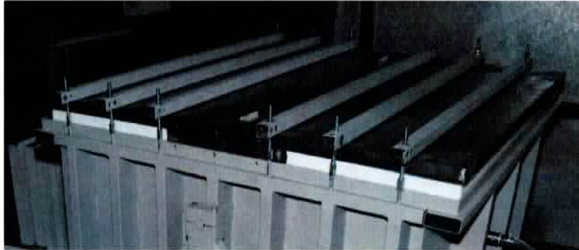
Bild 4-2: Luftdichtheitsprüfstand mit eingebautem Probekörper
