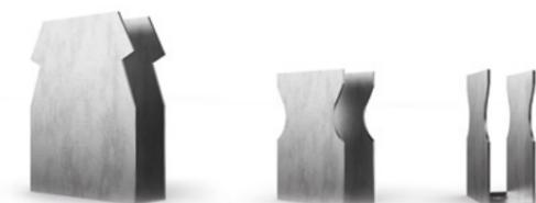
Wird COFRAPLUS® 220 mit Knaggen montiert, muss die offene Profilsicke am Ende mit einer Abdeckkappe verschlossen werden. Die Kappe wird im Untergurt mit dem Profilblech verschraubt.
