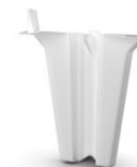
Das speziell geformte Z-Profil ist ebenfalls zur Abdichtung für COFRAPLUS® 220 in der Knaggenvariante vorgesehen. Es wird zwischen den Knaggen auf dem Stahlträger montiert.
