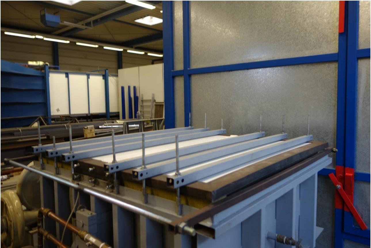
Abbildung 2: Luftdichtheitsprüfstand mit eingebautem Prüfkörper
