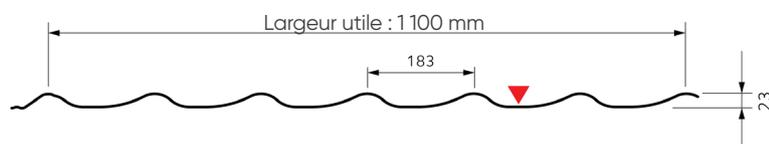
Longueur de profilage : Minimale 1 800 mm / Maximale 8 000 mm
